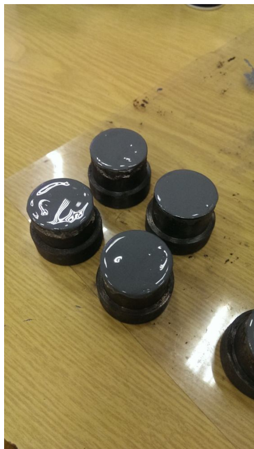
Рис. 3.6. Образцы с нанесённым композитом для испытаний на отрыв
