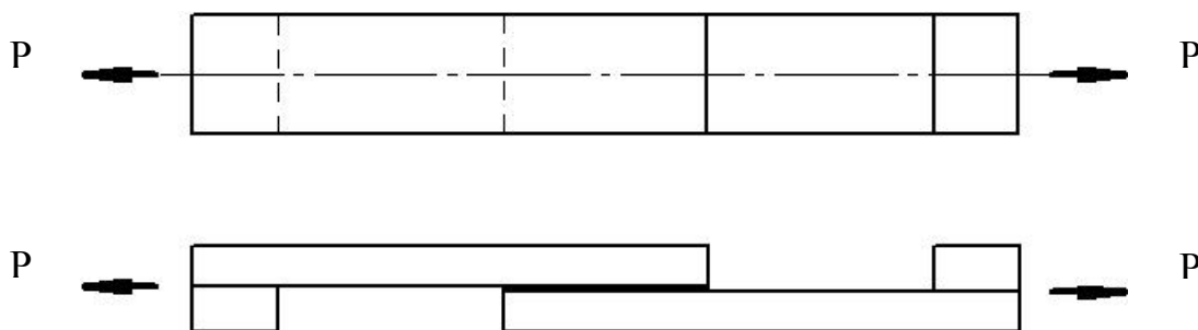
Рис. 3.3. Схема нагружения при испытании на сдвиг растяжением.
