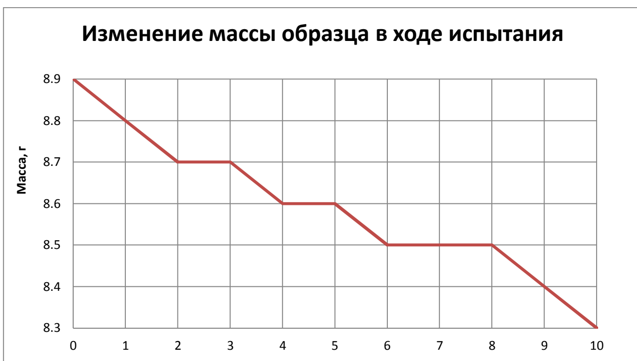
Рис.3.31. Потери массы образца с нанесённым материалом Ceramic FSL в течение 10 часов
