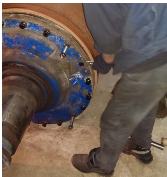
Рис. 4.14. Крепление цапфы на валу
