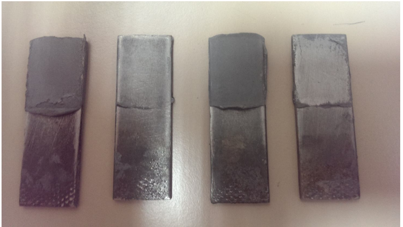
Рис. 3.11. Образцы после испытаний на сдвиг
