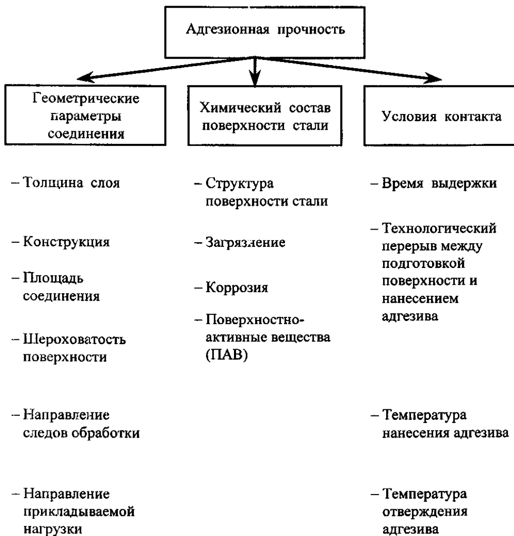
Рис.2.15. Основные технологические параметры, влияющие на прочность адгезионных соединений
