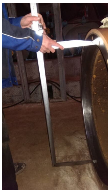
Рис. 4.10. Контрольное измерение внутреннего диаметра вала
