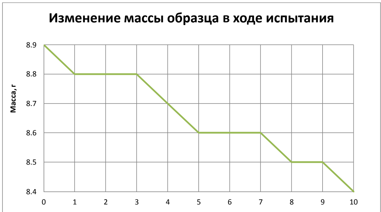
Рис.3.32. Потери массы образца с нанесённым материалом Ceramic FHT в течение 10 часов
