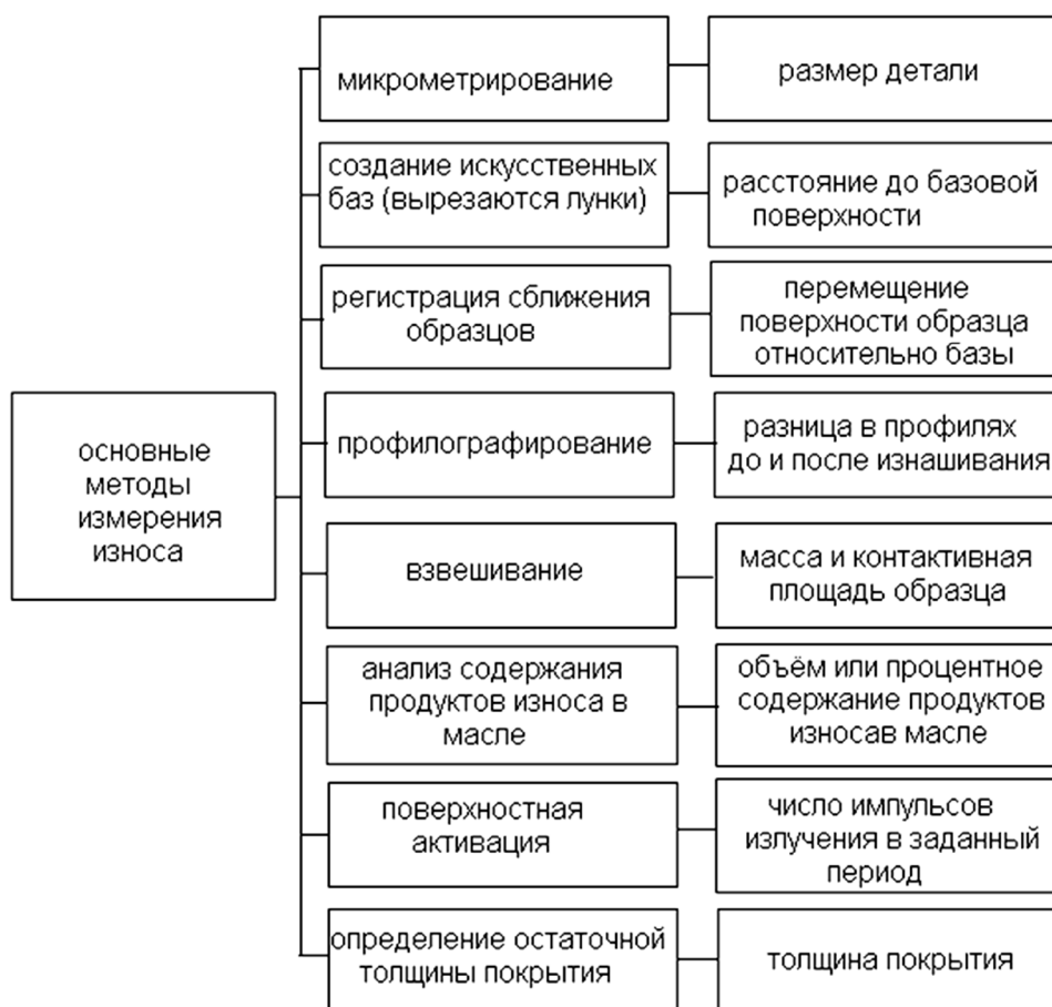
Рис. 2.19. Методы измерения износа и измеряемые величины.
