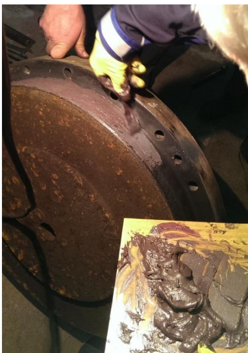
Рис. 4.11. Нанесение РКМ на цапфу (основной слой)
