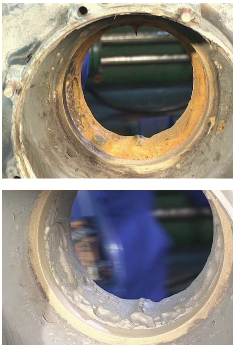
Рис. 1.5. Износ внутренней поверхности улитки центробежного насоса
