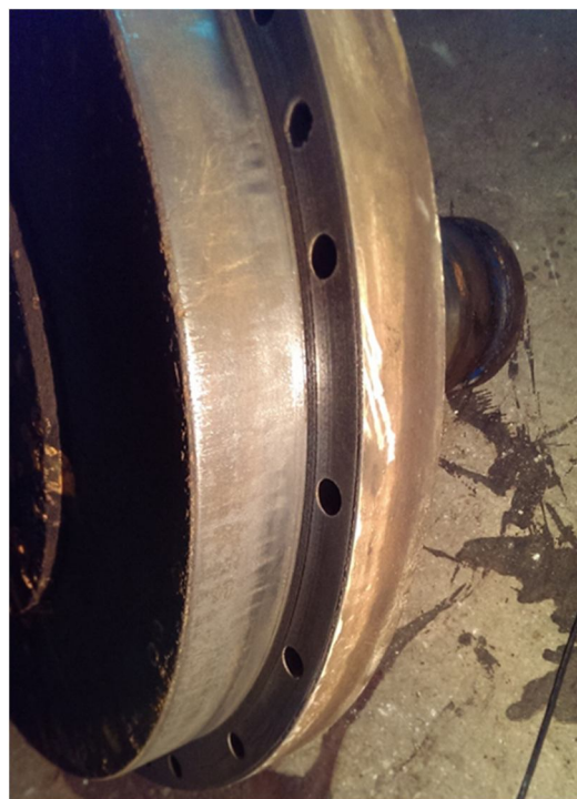
Рис.4.4 Цапфа прессового вала БДМ до ремонта
