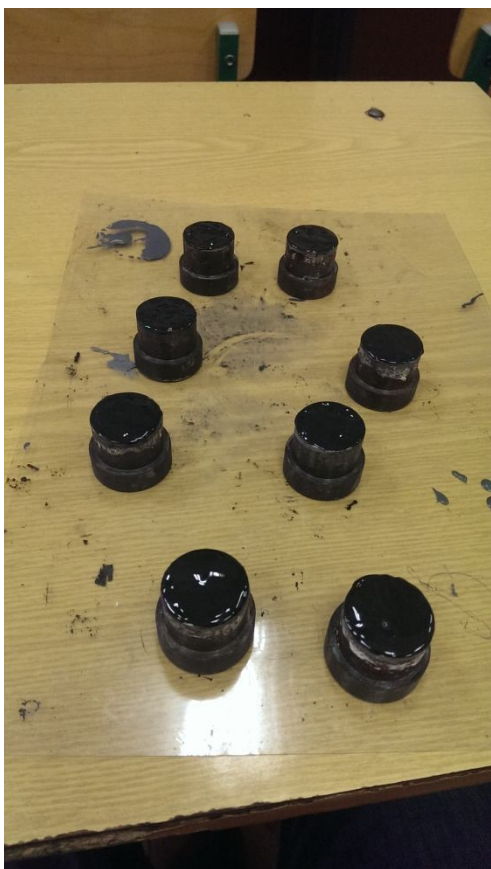
Рис. 3.6. Образцы с нанесённым композитом для испытаний на отрыв
