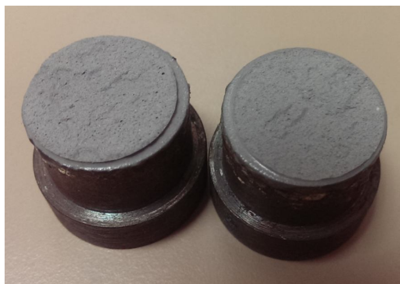
Рис. 3.10. Образец после испытаний на отрыв
