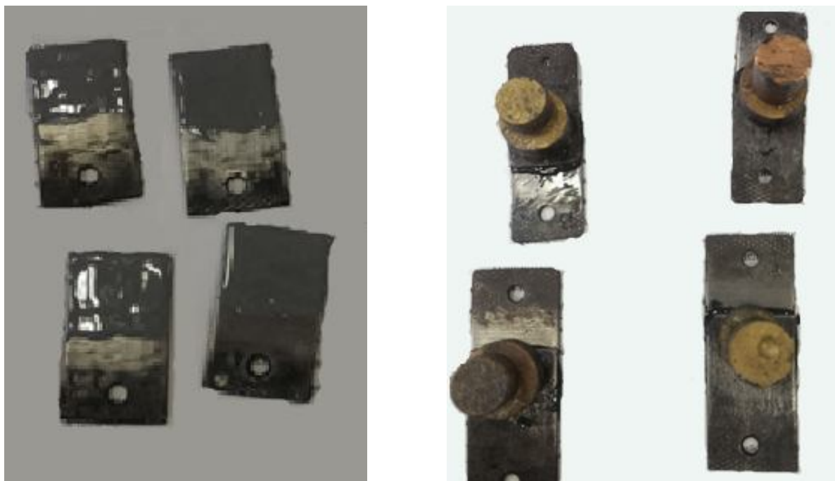
Рис. 3.2. Образцы с нанесённым компаундом для испытаний на сдвиг.
