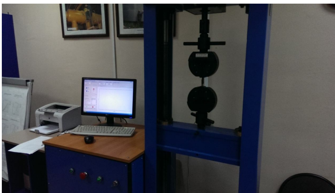
Рис. 3.8. Общий вид модернизированной разрывной машины Р-5
