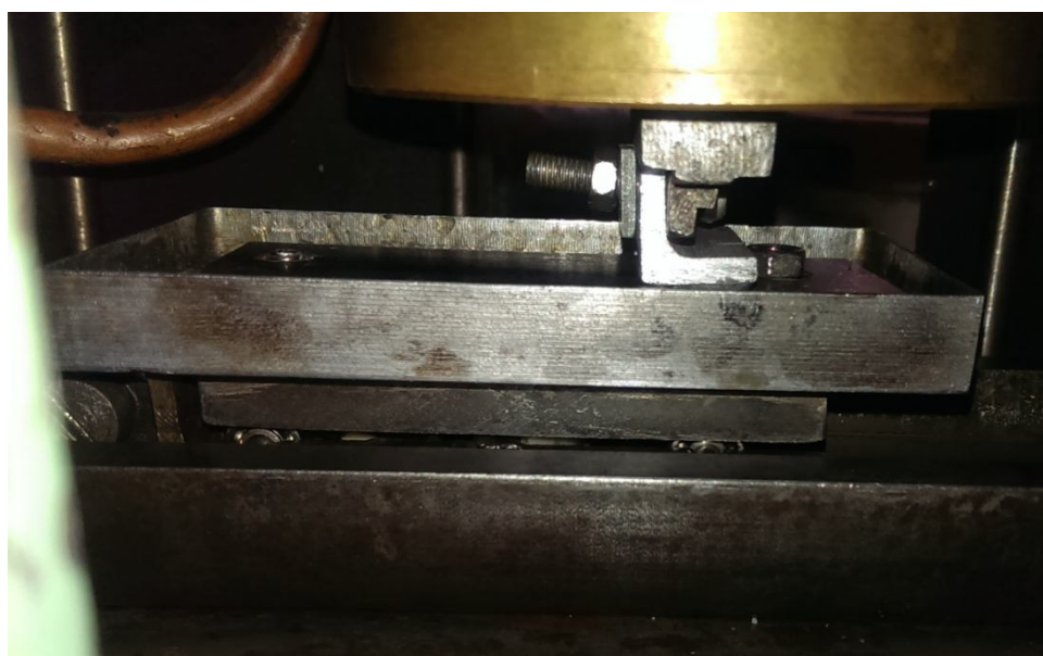
Рис. 3.29. Установленный в держатель образец для испытания на износостойкость
